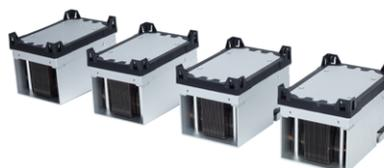
TC1 Pro 和 TC4 Pro 温控台采用半导体制冷技术，兼具加热和制冷的功能，复合式冷却系统，升降温速率快，具有外包防冷凝水材质，减少冷凝水的产生。由控制模组和温控模组两部分组成，自带触控显示屏，易操作观察，可单机使用，也可通过 RS-485 通讯接口连接上位机进行控制。温控范围为 4°C~85°C。TC4 Pro 基于 TC1 Pro 开发，一个控制模组连接 4 个温控模组，且 4 个控制模组可设置不同的温度。
