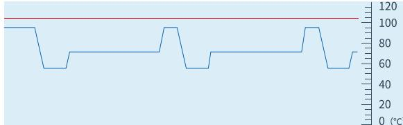
界面蓝色区域，显示当前热盖与模块的实时温度。红线为热盖温度曲线、蓝线为模块温度曲线。
